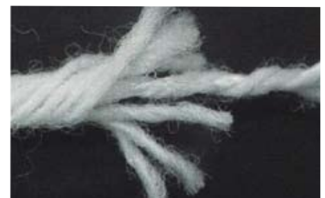
Fig. 9: Hilo hilado con alma astil
