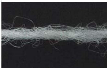
Fig. 8: Hilo hilado cuando se retira su torsión
