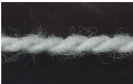
Fig. 7: Hilo hilado retorcido
